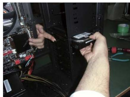
クイックリリースレバーも少し浮かせてハードディスクを水平に引っ張り出します。取り付けは逆の手順で OK!!
