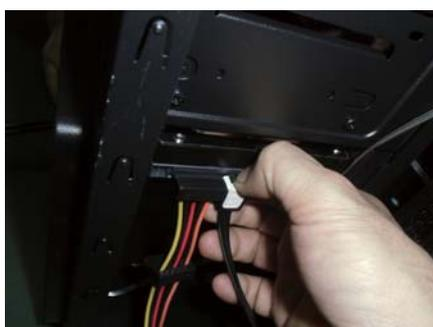
ラッチを摘んでコネクタを外します。HDD に対して水平に引き抜きましょう！電源コネクタも一緒にね！
